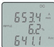
**Le Ripple (taux d'ondulation est un paramètre qui permet de quantifier la qualité du lissage** dans le cas de courants redressés puis lissés (continus).
