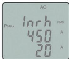
La connaissance du courant de démarrage est indispensable au dimensionnement d'une installation électrique (interrupteur principal, relais, fusibles...). En effet, **ce courant "d'appel" peut atteindre jusqu'à 20 fois le courant nominal du régime établi**, ce qui nécessite d'utiliser des dispositifs de protection adaptés.
