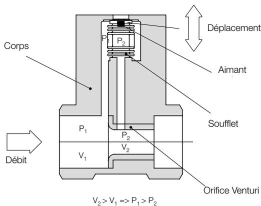
Dans le corps de l'appareil et positionné à des endroits bien définis nous trouvons les deux prises de pression permettant de transmettre l'information à une cellule de pression différentielle. La cellule de pression différentielle est protégée par des butées en cas de dépassement du débit maxi. La valeur de débit est transmise, par l'intermédiaire d'un mouvement mécanique, à un affichage calibré en L /min pour l'eau ou Nm<sup>3</sup>/h pour l'air.
