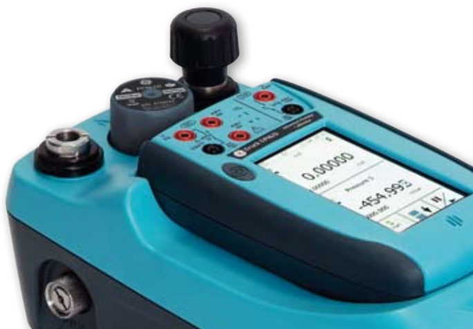
Génération et mesure de pression interchangeable à partir de 25 mbar (10 inH 2 O) à 1 000 bar (15 000 psi)
