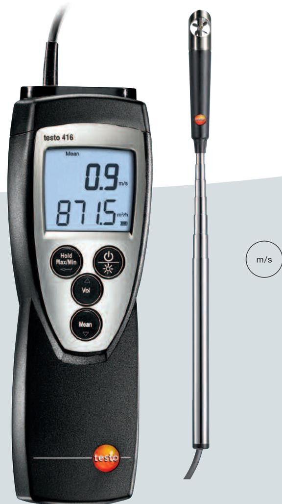
Le testo 416 est un anémomètre compact avec sonde à hélice télescopique (long. max. 890 mm, diamètre 16 mm). Le débit dont le calcul est très précis, grâce à la possibilité de saisir avec exactitude la surface du conduit, est indiqué directement à l'affichage.
