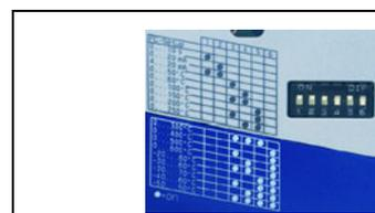
Le commutateur DIP permet de choisir l'étendue de mesure et de régler le comportement de la sortie. Le logiciel Setup pour PC permet de configurer d'autres étendues de mesure et paramètres.
