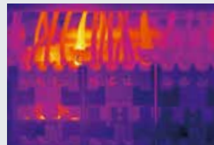
Entretien des installations : détecter des températures trop élevées au niveau des fusibles et des composants électriques avant que des pannes ne se produisent.
