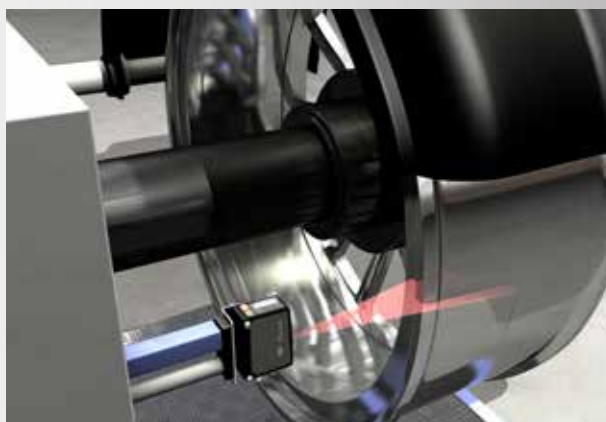
Contrôle d'excentricité de jantes Le capteur OM70 multi-spot permet un contrôle qualité optimal des jantes en alu brillantes. La mesure du profil de la jante permet de vérifier la bonne rotation des roues.
