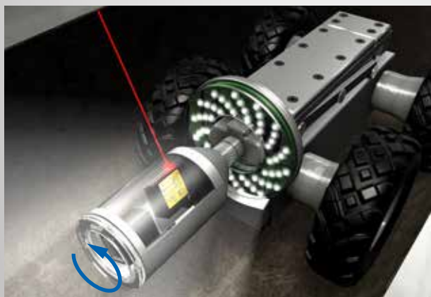
Inspection de la qualité des tuyaux d'égout Une mesure de l'excentricité à l'intérieur d'un tuyau d'égout étroit permet de contrôler s'il est endommagé ou fissuré.
