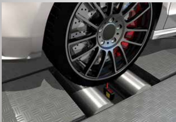
Mesure du profil de pneus
