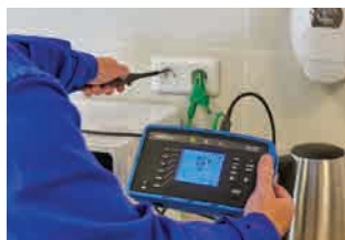
Voyant PASS/FAIL pour visualisation instantanée du résultat.
