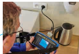
Cordon tripode pour mesures directes sur prise 2P+T.
