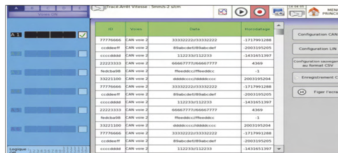
Visualisation des trames complètes en fonction du BUS sélectionné
