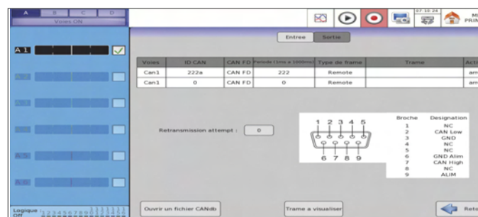
Envoi de trames sur le Bus CAN
