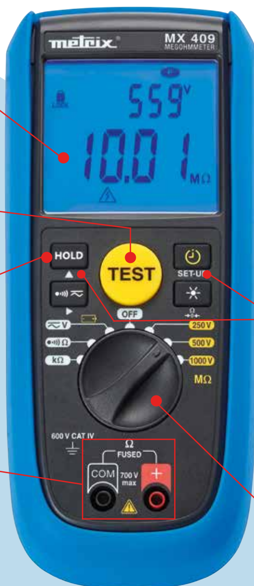
Ecran LCD rétro-éclairé, double afficheur numérique : valeur d'isolement et tension réelle
