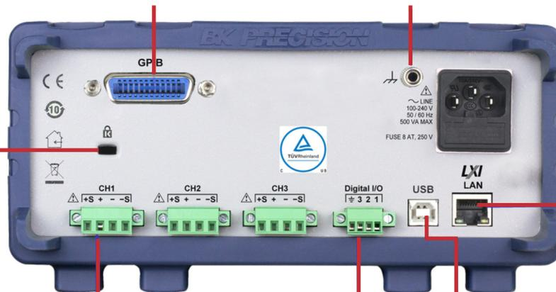
**Interface LAN compatible LXI**
