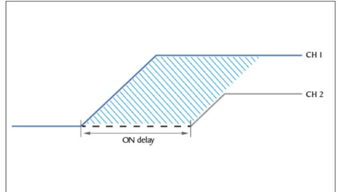
Les microcontrôleurs et autres appareils de traitement nécessitent souvent des séquences d'alimentation spécifiques au démarrage pour fonctionner correctement. Le mode de couplage, les retards de sortie et la vitesse de balayage de la série BK9140 peuvent être configurés pour produire des séquences de mise sous tension pour les applications de test de microcontrôleurs.
