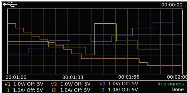
Ces alimentations offrent un mode d'affichage graphique pour surveiller et observer visuellement les données de tension et de courant mesurées sur les trois voies tension / courant.
