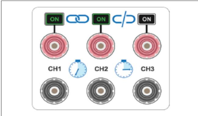
Le couplage de voie relie les sorties de plusieurs voies. Les délais d'activation et de désactivation des sorties peuvent être réglés de zéro à 1 heure par incréments de 0,1s pour chaque voie.
