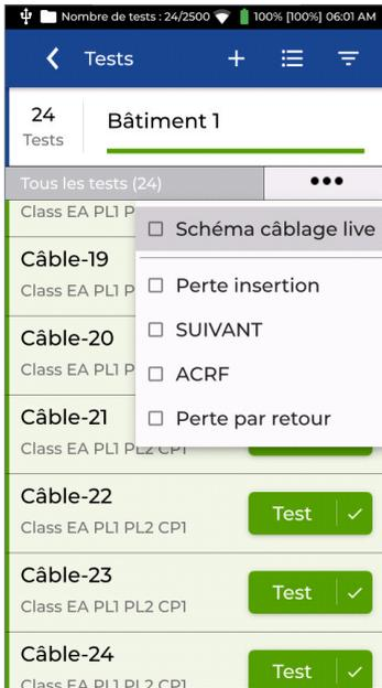
Sélectionnez Schéma câblage en direct pour afficher en temps réel le test de la continuité physique des paires.
