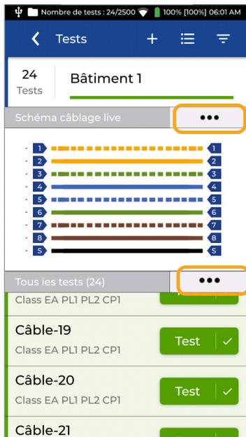
La fonction de plan de câblage en temps réel permet de vérifier les continuités avant d'exécuter l'Autotest ou en cas de mauvais contact pour essayer de le localiser sur l'un ou l'autre des connecteurs.
