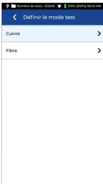
La première étape consiste à sélectionner un type de mesures : sur lien cuivre ou de fibre optique.
