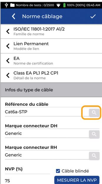
Ensuite on définit la nature du lien testé dans l'onglet "Infos du type de câble". Ceci n'impactera pas sur les seuils et a pour finalité de renseigner plus en détail la nature des composants installés : le câble rigide avec éventuellement sa marque et sa NVP - et les connecteurs (et la marque aussi si besoin).
