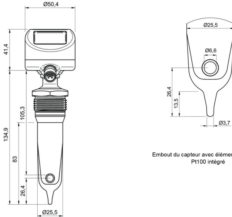
Embout du capteur avec élément de capteur
