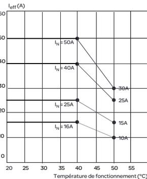
Les courbes de déclassement du courant sont données en fonction de la température ambiante
