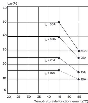
Les courbes de déclassement du courant sont données en fonction de la température ambiante
