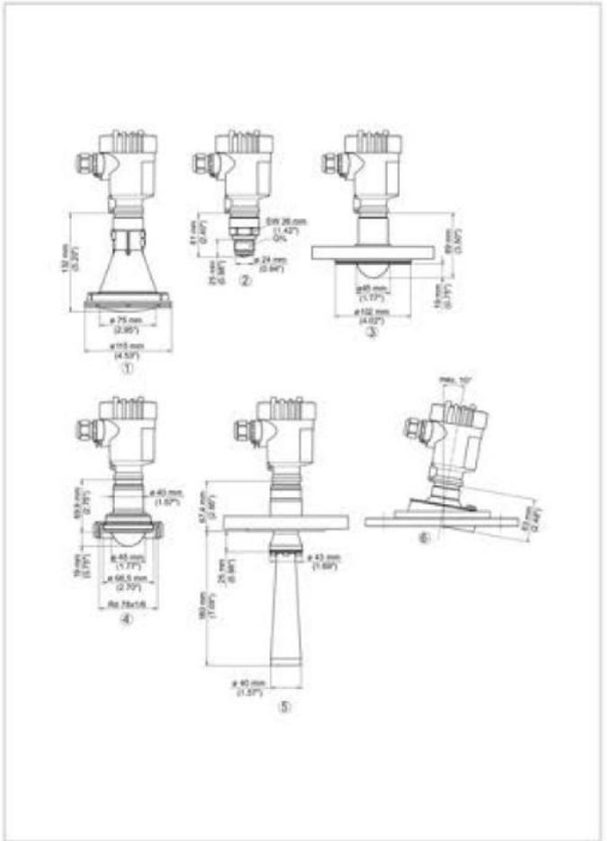
Dimensions et versions d'antenne VEGAPULS 6X
