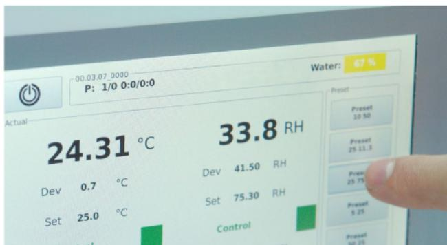
À l'aide de l'écran tactile, les valeurs de mesure peuvent être facilement contrôlées. La structure claire des menus permet une utilisation intuitive. De plus, des messages d'aide sont à votre disposition. La programmation de l' Huminator II se fait en seulement quelques étapes par l'écran tactile. Au besoin, cette opération peut également être réalisée par l'interface USB.
