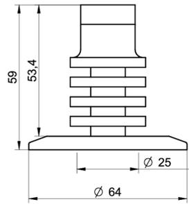
Tri-Clamp Ø 50.5, membrane Ø 25 mm (BCID: C04) avec col de refroidissement
