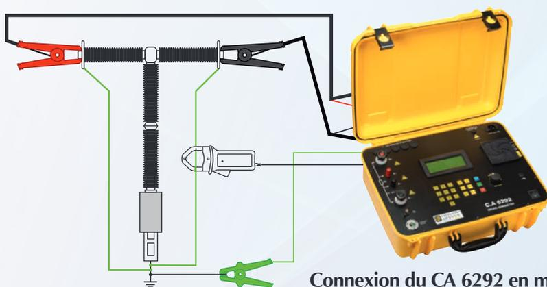
Connexion du CA 6292 en mesure en mode BSG
