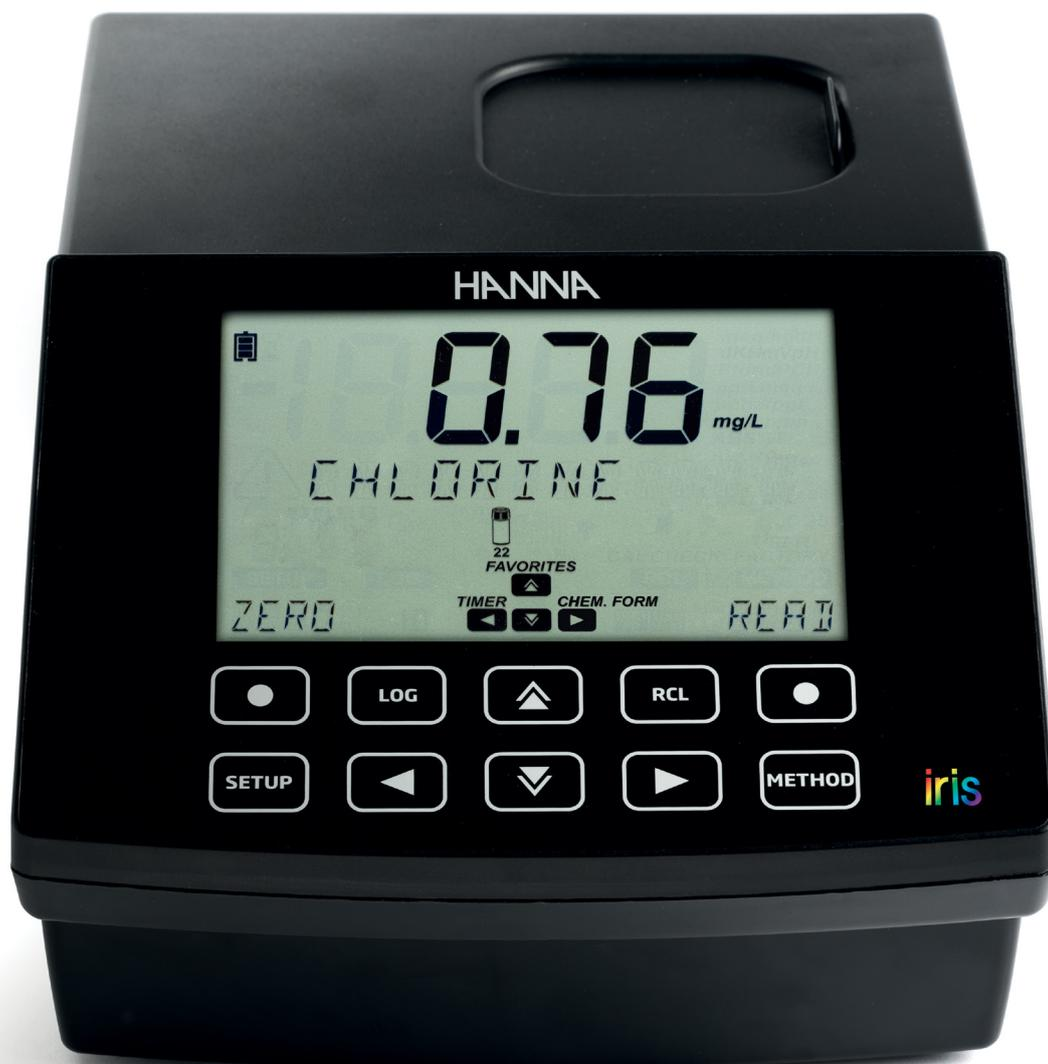
À l'instar des photomètres classiques à longueurs d'onde prédéfinies, **HI801 iris** permet de mesurer avec l'entière étendue de longueurs d'onde de la lumière visible (lumière blanche).
