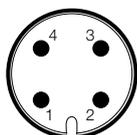
Sortie analogique/sortie contact/sortie impulsions
